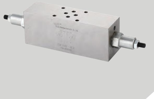
钢体阀。A→A1, B→B1通过单向阀自由开启; A1→A, B1→B通过单向阀密闭, 由可调先导阀控制开启。连接方式: ISO CETOP3 建议应用于开式平衡控制。
