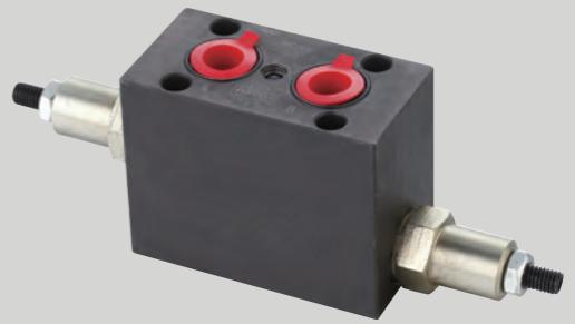
MOV型叠加式平衡阀通过对A口和B口的控制来调节进出执行器的流量,从而达到对负载进行动态与静态的控制,这类阀包含两部分,每部分都由一个单向阀和一个带先导相互控制的溢流阀组成,单向阀允许油液正向自由流向执行器,反向则截止,先导压力相互交叉控制,溢流阀的设定压力被比例的减小,直到阀口被打开允许油液反向流动,A1口或B1口的背压会附加到弹簧设定压力上。
