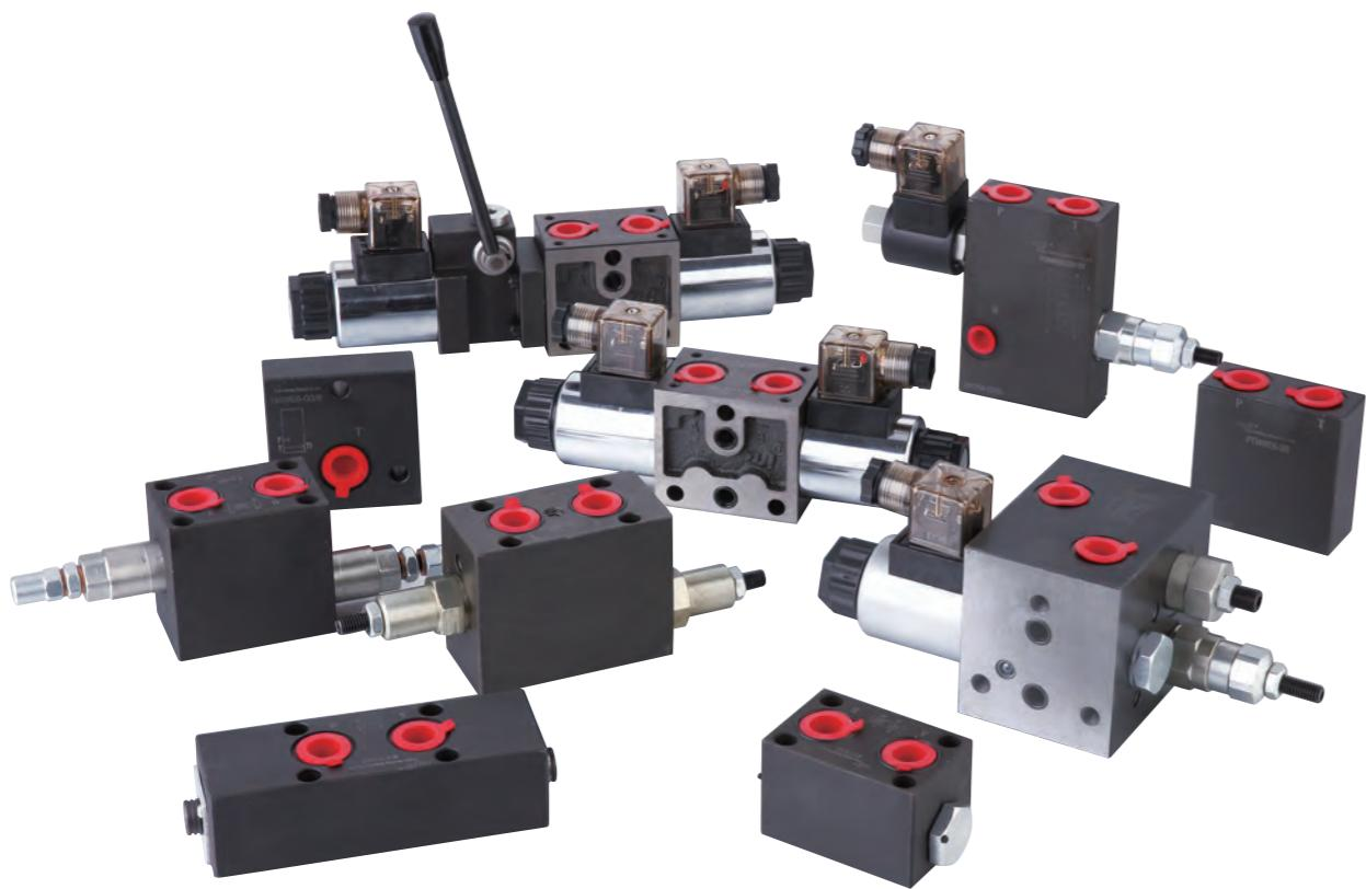
MDWE6阀组系列是一种新型的模块式换向阀组，主要由泵侧模块，换向阀模块，叠加阀，侧盖模块以及相应的安装配件组成。模块式阀组可以不通过油路块而直接与油管连接，这种紧凑的结构设计使阀组安装尺寸更小，同时也节省了油路块的成本。
