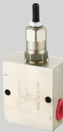
HDR系列带遥控口的溢流阀是一种直动式的溢流阀，用来限制系统的压力，它具有结构紧凑、性能优良、工作可靠、低噪音和使用寿命长等特点，被广泛运用于小流量系统。
