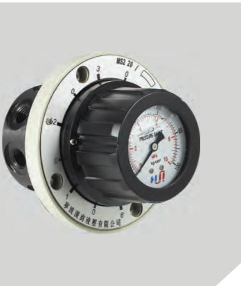
AM6E型压力开关为转阀式开关，借助于旋转的阀套，用一个压力表可读出六个油路的压力。
