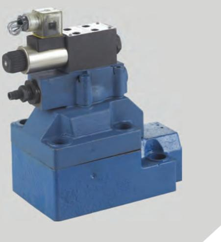
PA/PAW型阀是先导控制的卸荷溢流阀。此系列主要作用是在有蓄能器系统中当蓄能器工作时使油泵卸荷；在高低压油泵系统中使高压泵工作，使低压泵卸荷。
