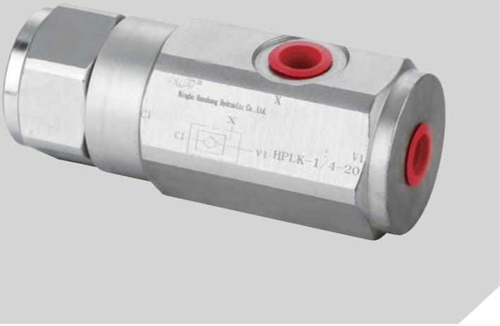
当V1口压力升高至弹簧设定压力时，阀芯被顶起脱离阀座，油液从V1到C1可以自由流动，正常状态下从C1到V1阀是关闭的，当X口的先导压力足够大时，先导油作用在先导活塞上推动阀芯脱离阀座油液可以从C1到V1自由流动，在阀处于截止状态时，阀为零泄漏。
