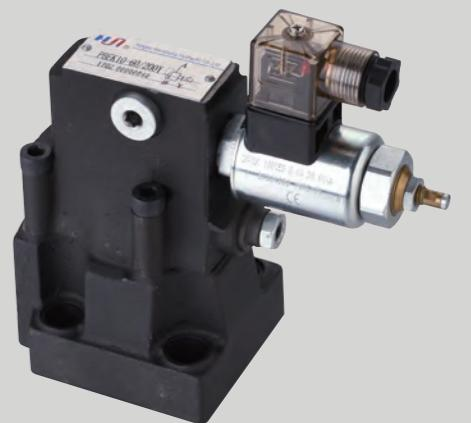
PBE型阀是座阀结构的先导式溢流阀，用这种阀，系统压力可随电气输入信号，连续改变，压力的极限由磁铁设定，与电流有关。PBEK型溢流阀，在PBE型溢流阀基础上加装一个弹簧加载的压力溢流阀，提供最高压力保护。
