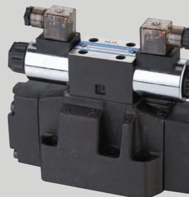
DWHG型电液换向阀是用电磁换向阀作为先导控制的滑阀式换向阀，用于控制液流的通断和流动方向。
