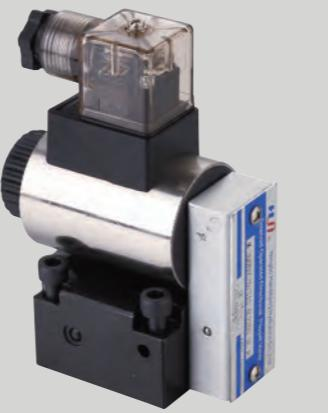
QDE型方向阀是电磁铁操作的钢球式换向阀，用于控制油液的开启、停止和液流的方向。常用于保压回路。
