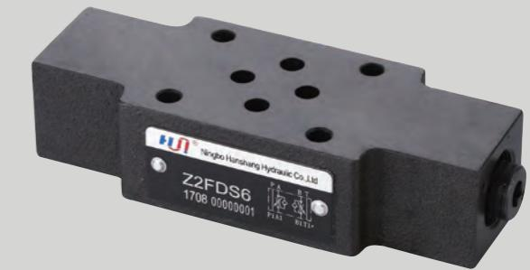
Z2FDS 型叠加式双单向节流阀通过改变节流口断面大小来调节油路流量，从而实现流量控制，在反向时，液压油直接通过单向阀回油。
