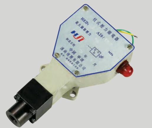
AED1型柱塞式压力继电器为液—电压力继电器，用于某段油路达到调定压力时，压力继电器即发出电讯号，控制某些电气元件的通、断。实现系统的顺序动作或做安全保护。
