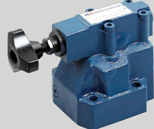
PZ型先导式顺序阀用来控制执行元件的先后动作顺序，以实现液压系统的自动控制。该阀有两种连接形式和四种控制油形式，通过改变控制油控制形式可得到不同的功能。
