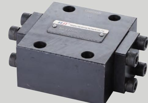
DSV/DSL型液控单向阀只允许油液从正向通过，反向则截止，可用作保压。当接通控制口X时，压力油可反向流动。
