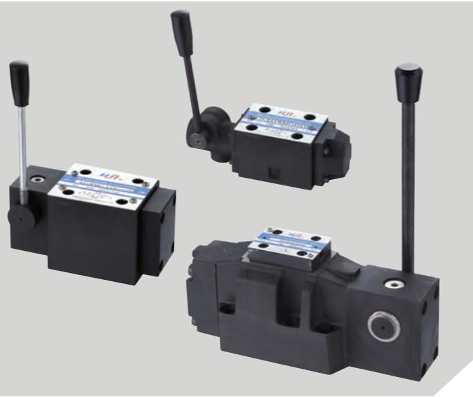
DWMG 型手动换向阀是通过手柄的操作使阀芯做轴向移动，从而对油路进行切换的直动式换向阀，采用定位器或弹簧复位装置。
