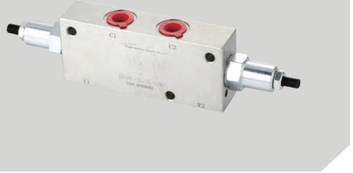
HOW系列双向平衡阀通过对C1口和C2口的控制来调节进出执行器的流量,从而达到对负载进行动态与静态的控制,这类阀包含两部分,每部分都由一个单向阀和一个带先导相互控制的溢流阀组成,单向阀允许油液正向自由流向执行器,反向则截止,先导压力相互交叉控制,溢流阀的设定压力被比例的减小,直到阀口被打开允许油液反向流动,V1口或V2口的背压会附加到弹簧设定压力上。
