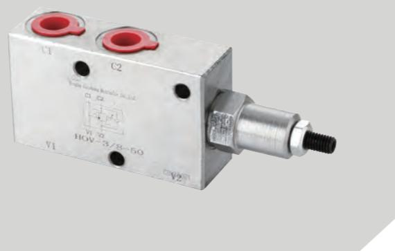
当V2口的压力升高到单向阀调定的压力时,阀芯被推离阀座,油液可以从V2到C2自由流动,当作用在C2口的负载压力足够大时,作用在阀芯环形面积差上的力大于弹簧设定的压力时,油液可以从C2口流向V2口,阀起溢流作用。根据阀所具有的先导压力比,V1-C1的先导压力与弹簧的设定压力相比被比例的减小直到阀芯打开,油液可以C2口到V2口自由流动,弹簧腔与V2口相通,V2口的背压要附加到弹簧设定压力上。
